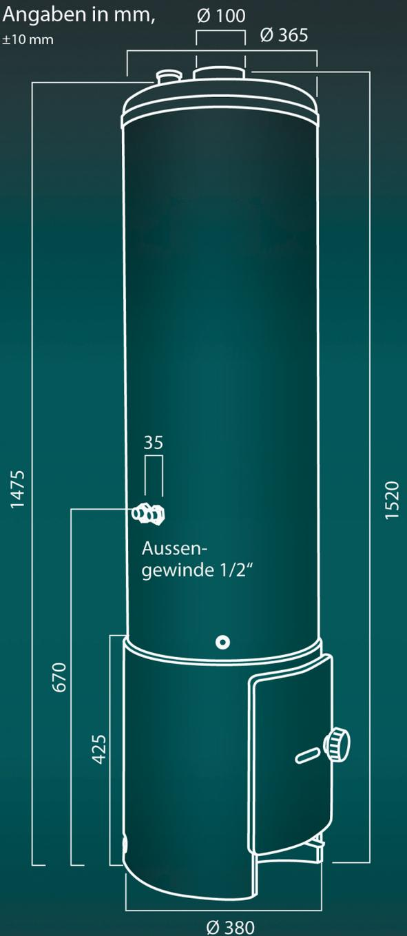
Der Ofen erhitzt nicht nur das Wasser im 100 Liter fassenden Behälter sondern schafft gleichzeitig auch wohlige Wärme im Badezimmer. Das Ganze funktioniert nach dem Überlaufprinzip und einer Mischbatterie mit Überdruckfunktion und Belüftung. Diese ergibt mit der seriellen Handbrause und dem
