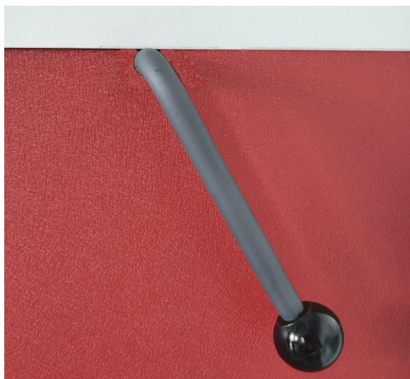
Abbildung 7: Kurzschlussklappenhebel in geöffneter Stellung.
