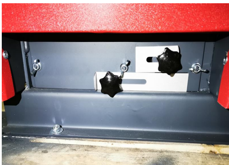
Abbildung 9: Lage der Klappen für die Sekundärluftzufuhr
