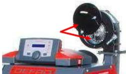
Vor dem Betrieb mit einem Feuerzugsregler muss der Drosseldeckel an dem Gebläse nach unten gestellt werden, so dass die Luft einsaugende Fläche vom Gebläse ganz bedeckt ist.
