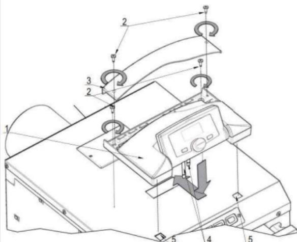
Schritt 1 - öffnen Sie den hinteren Deckel / Pos.3/ der Steuerung S3P /Pos. 1/
